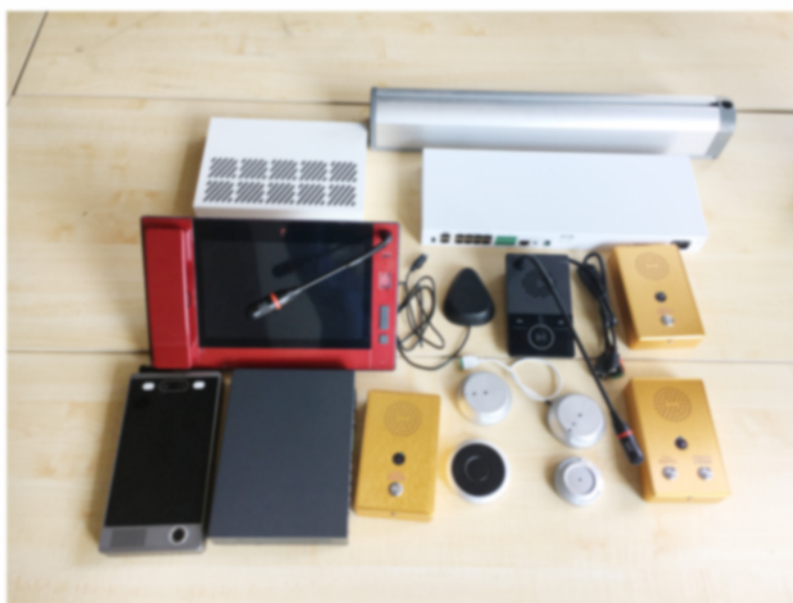
图一：MF-6700 型 IP 网络内部通信对讲系统外观
